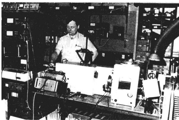
Rysunek 6. A. Rodzik przy dwuwieżkowym odbiciomierzu z automatyczną rejestracją danych.
