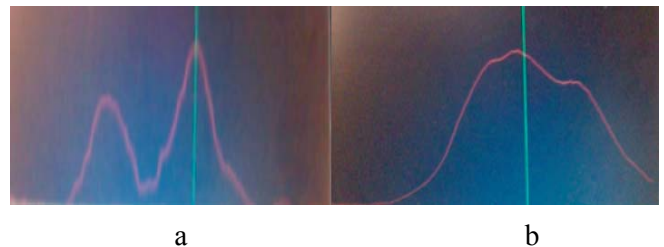
Rys. 9. Kształt linii luminescencyjnej rubinu: prawidłowy (a) i nieprawidłowy (b). Znaczne poszerzenie i nieregularny kształt świadczą o znacznych naprężeniach w kryształach rubinu w przypadku (b).
