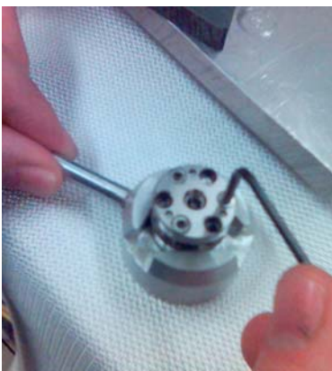
Rys. 5. Redukcja odległości pomiędzy kowadłami dla miniaturowej komory ciśnieniowej (Danvils). Zmiana odległości kowadł o kilka mikrometrów dokonywana jest poprzez dokręcenie trzech (w danym przypadku) śrubek o kąt kilku stopni.
