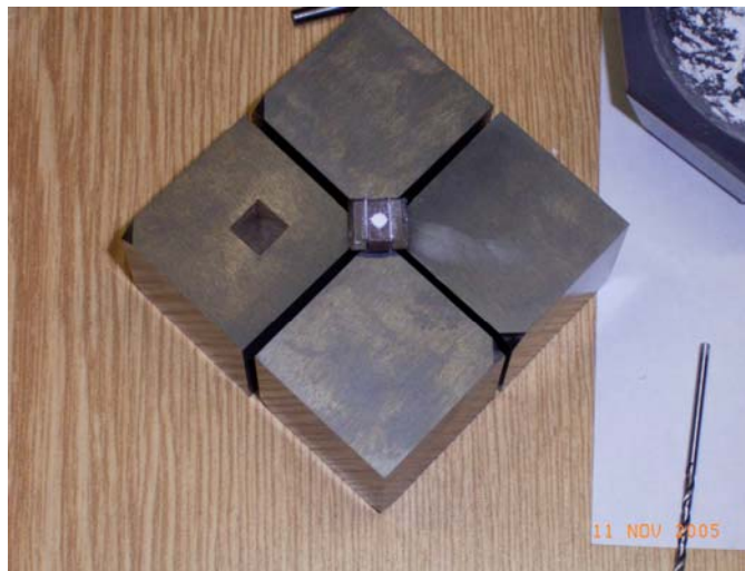
Rys. 14. Układ wewnętrznych kowadeł w prasie MAX200x. Widoczne są cztery dolne oraz ośmiościenna próbka umieszczona pomiędzy nimi. (Fot.: Christian Lathe).
