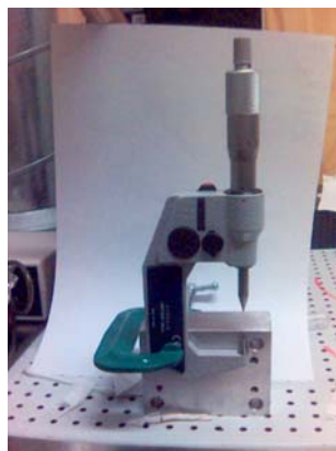
Rys. 6. Zwykły mikrometr zamocowany do bloku metalu w celu umożliwienia pomiaru miniaturowej grubości komory ciśnieniowej z precyzją ok. 1 \mu\text{m} .
