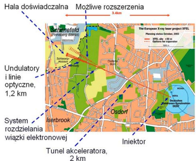
Rys. 3. Schemat budowy XFEL nałożony na mapę Hamburga.
