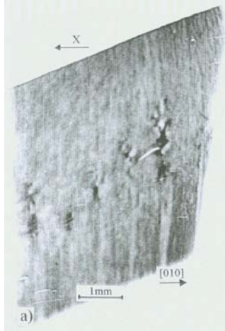
Rysunek 2. Synchrotronowa odbiciowa topografia w wiązce białej próbki A2.
