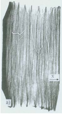
Rysunek 1. Synchrotronowa odbiciowa topografia w wiązce białej próbki A1.
